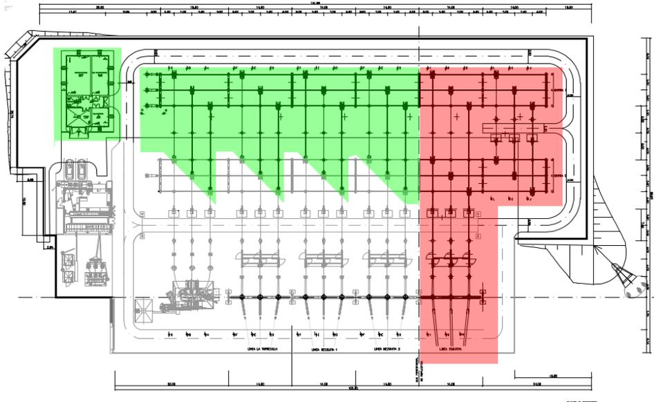
En el siguiente plano, en color blanco se indica el estado previo de la plataforma de las SE de Valdeconejos 220 kV. En azul, verde y rojo se observa el alcance de todos los trabajos necesarios para poder dar cumplimiento al procedimiento de operación.
