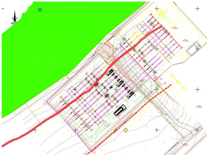
Según se aprecia en la figura la subestación proyectada invade el margen de protección lineal indicado en la normativa, este incumplimiento hace inviable la construcción de esta solución.
