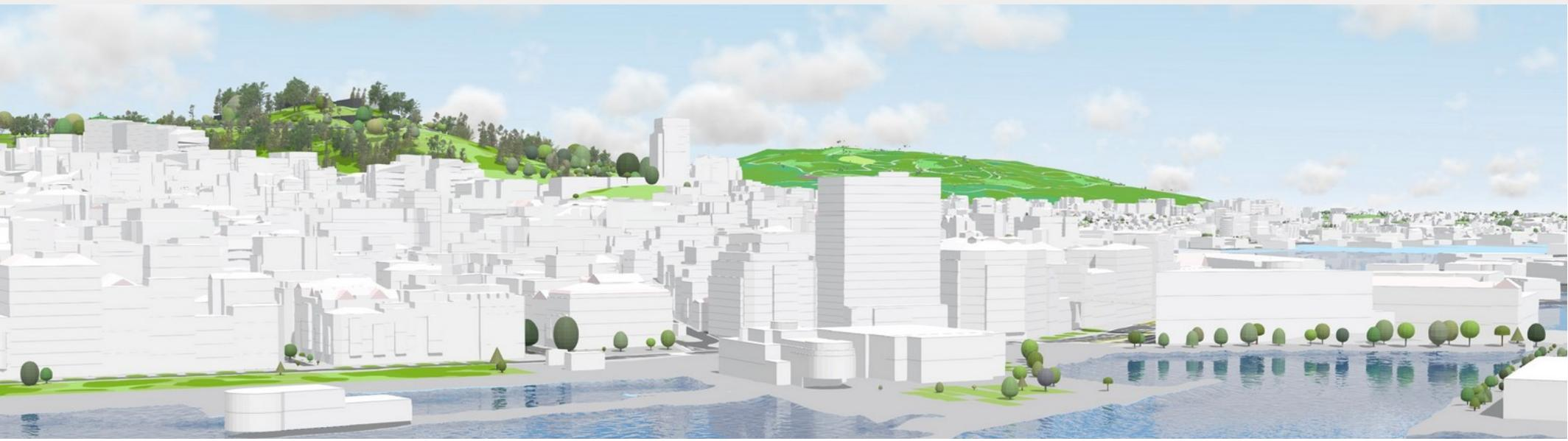
A partir de los datos de edificios, modelos digitales del terreno, cartografía y nubes de puntos se modela la ciudad obteniendo un **"gemelo digital 3D"** de Vigo.
